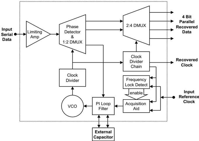
Figure 13.6.1: IC block diagram.
